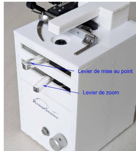
Figure 41 : Les leviers en fin de montage
