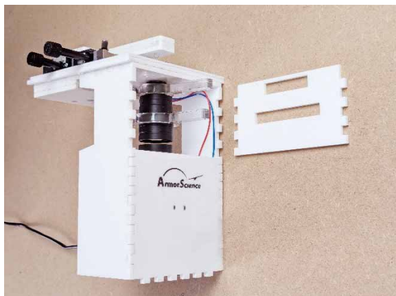
Figure 43 : Fixation de l'objectif
