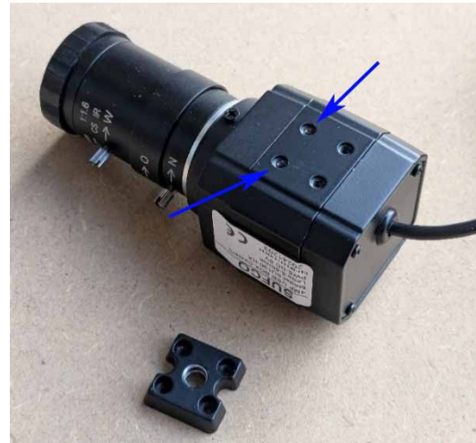
Figure 36 : Le socle de fixation démonté
