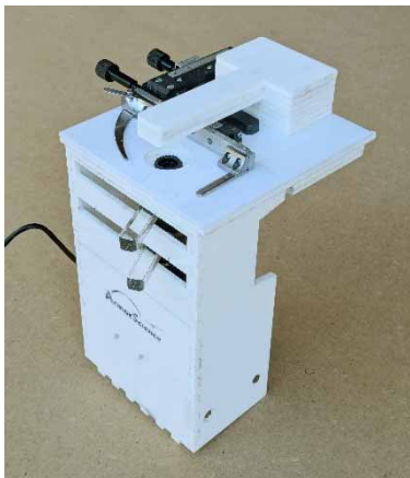
Figure 8 : Châssis interne monté vu de devant
