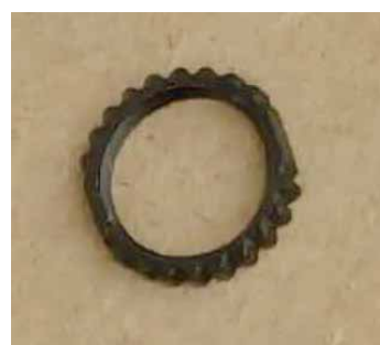
Figure 46 : gros plan sur la bague de fixation
