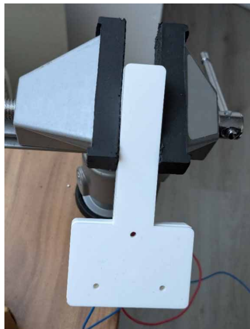
Figure 18 : Le support de LED terminé (vue de dessus)
