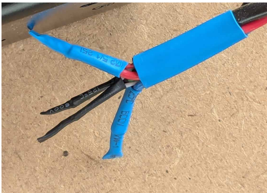
Figure 32 : protéger par des gaines
