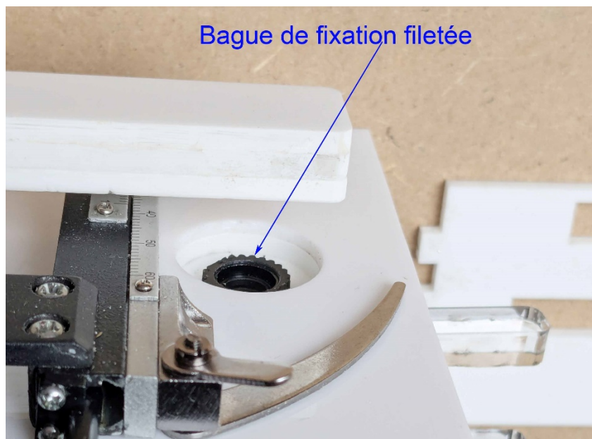
Figure 45 : Serrage de l'objectif par la bague de fixation filetée
