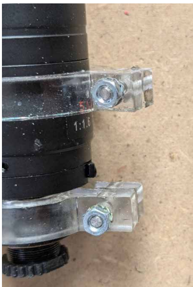
Figure 42 : Après ajustement, les leviers sont serrés sur l'objectif
